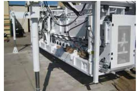
Al utilizar los soportes para el carguío del DBI, se puede cargar sin necesidad de uso de grúa.
