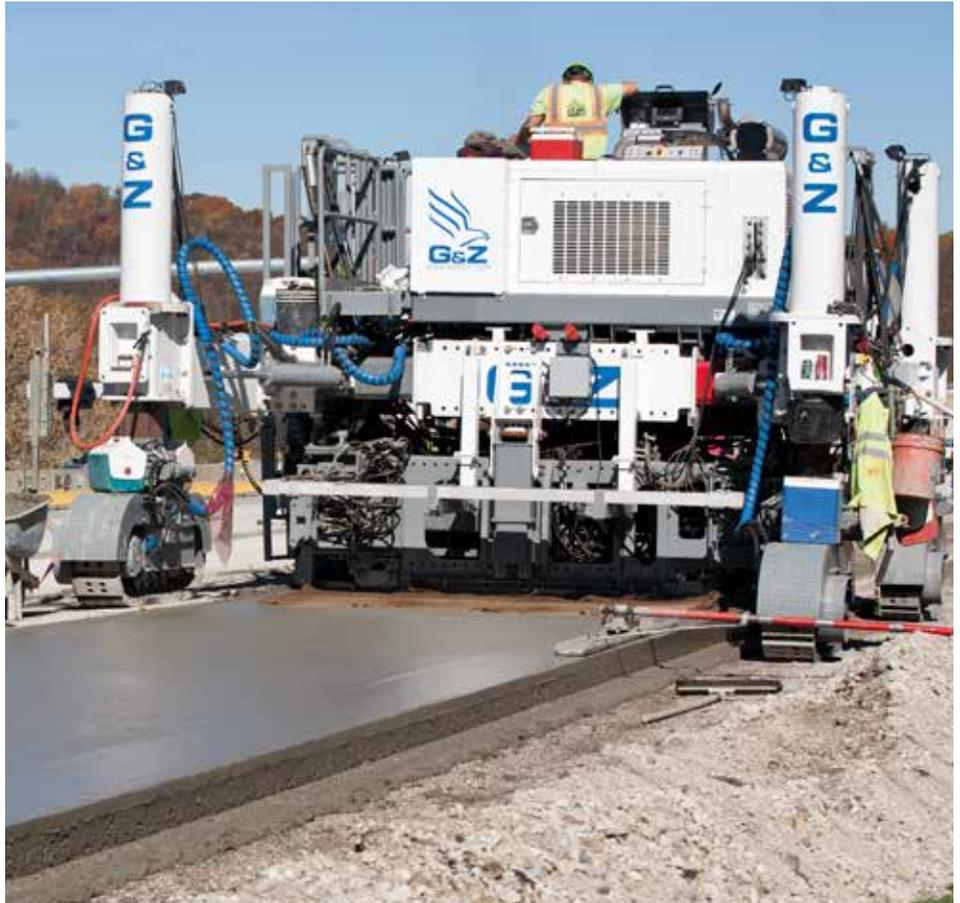
Los sistemas AccuSteer y SmartLeg llevan la productividad de la pavimentadora al próximo nivel. Los dos sistemas funcionan en tándem para ajustar el ángulo de la columna de elevación y dirección pivotante sobre la marcha, mientras que el tren de rodaje se dirige automáticamente hacia adelante. Estos dos sistemas reconfiguran rápida y semiautomáticamente la máquina en la configuración de transporte.
