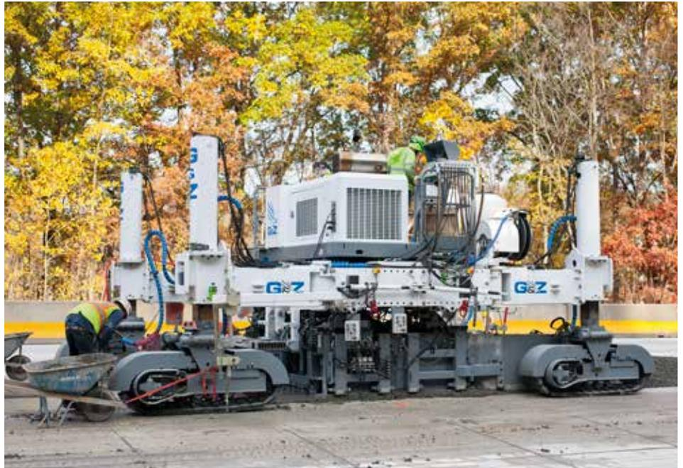
El patrón empernado universal en los laterales de la pavimentadora concuerda con el empernado del bastidor central. Este patrón de empernado permite que complementos como mástiles sin cables sean montados según lo desee el contratista, como también moldes desplazados, cintas transportadoras y otros complementos montables en una variedad de formas para adaptar la máquina a las condiciones del lugar de trabajo.
