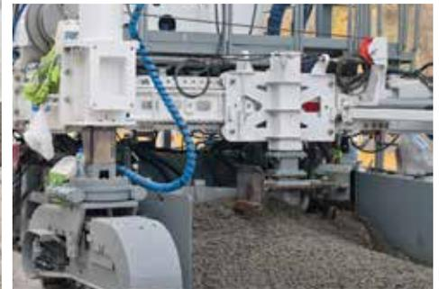
El potente arado distribuidor de concreto delantero distribuye más concreto, de forma más rápida y económica que un tornillo sin fin, y su ancho se puede modificar con mayor facilidad.
