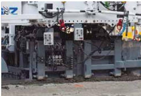
Las compuertas laterales compartidas de confinación tipo guillotina, son complementos que pueden ajustar de forma hidráulica las partes delantera y trasera de los moldes en forma independiente. La parte trasera puede desplegarse para vaciar y retirar una placa de concreto anteriormente vaciada, lo cual facilita la limpieza. Los cilindros hidráulicos de apertura y cierre son lo suficientemente potentes para cerrarse ante concreto plástico.
